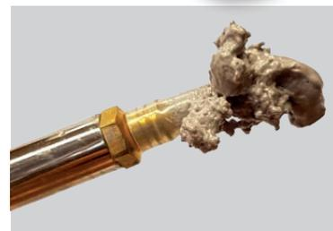
**Tipp:** Wenn Sie die maximale Ausbeute aus der Schaumdose und ein perfektes Schaumbild erhalten möchten, muss der PU-Schaum und der Untergrund befeuchtet werden, erst dann kann der Schaum sauber expandieren. Da die Fensterprofile immer dicker werden, ist es ratsam, von innen und außen zu schäumen oder auf zweimal von einer Seite, da der Schaum beim einmal Auftrag zu wenig Luftfeuchtigkeit bekommt und sich dadurch Löcher im Schaumbild bilden können.
