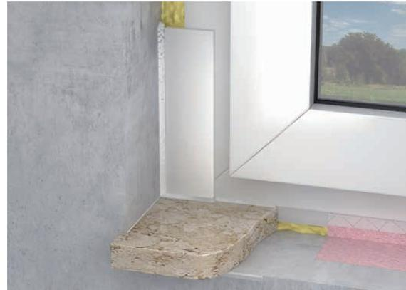
**Bei Altbauten** werden die Fensterbänke nicht entfernt. Nach Anbringen der RALMO®-Speed SK-Leiste wird umlaufend mit RALMO®-HYBRID window versiegelt.
