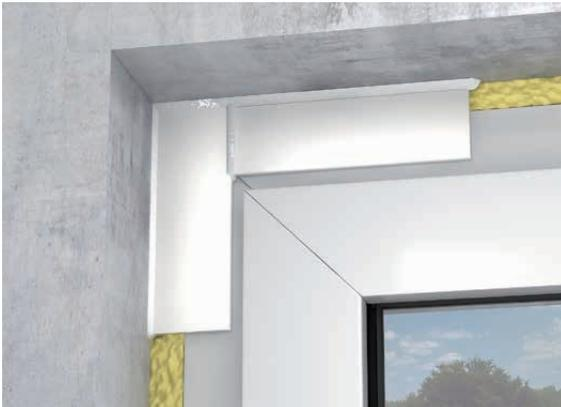
Die RALMO®-Speed SK-Leiste kann mithilfe ihrer Selbstklebung einfach und schnell auf den Blendrahmen geklebt werden. Die Gummilippe soll nur leicht anliegen, ein Abstand bis ca. 2 mm ist kein Problem. Abschließend werden alle Kontaktflächen, Gehrungen und Stöße mit RALMO®-HYBRID window versiegelt.
