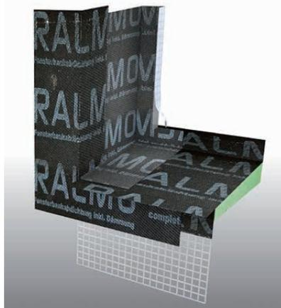
Diese Ecke wird 5° schräg geliefert für die Montage auf der Gefälledämmung, z. B. **RALMO<sup>®</sup>-FBA complete**. Sie ist mindestens 10 cm hoch und wird bei ca. 25–35 mm bauseits eingeschnitten, für den Rücken des Fensterblechs. Somit erhält man die Seitenverklebung und eine Wannbildung, dass Gewerke Loch ist perfekt dicht.
