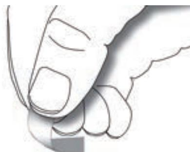
Der „Fingerlift“ zeichnet sich im Gegensatz zum einfachen RALMO®-Flexband durch einen überstehenden Liner/ Abzieher aus. Durch den Überstand können Sie den Liner/Abzieher besser greifen und dadurch einfacher abziehen.
